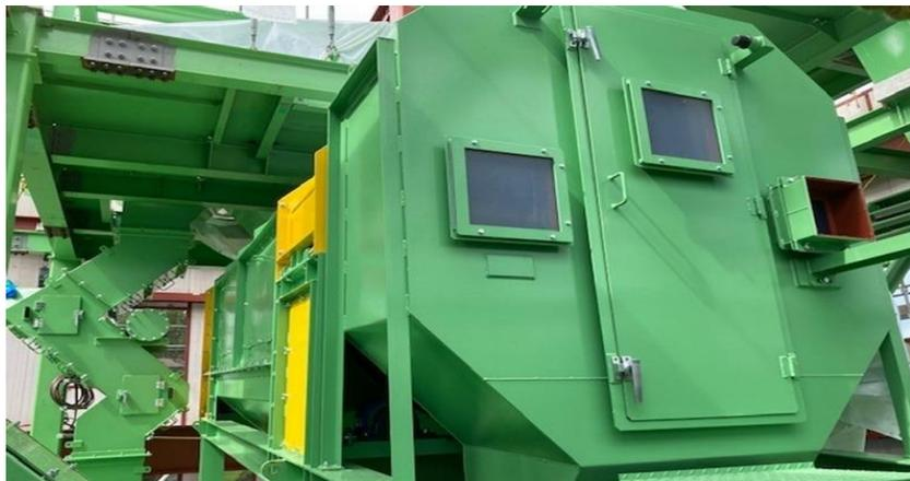
破碎したごみを粒度選別機で可燃残渣と不燃残渣に分けます。
