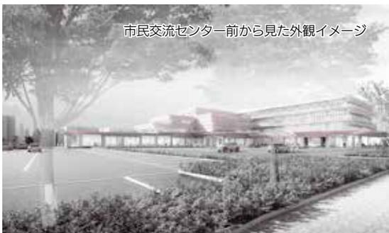
建物周辺にはメンテナンスや火災時の避難のためバルコニーを配置します。手すりは景観に配慮し木調のアルミ製とします。北側の窓を大きくし自然採光が確保できるようにします。
