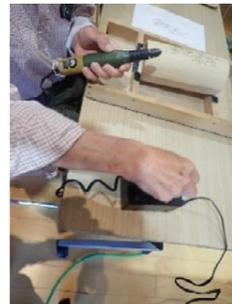
①ルーターに1.0のドリルを付けて竹を作業台に固定する
