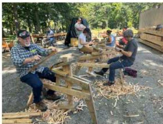
このプログラムでは、7日間で椅子を製作する。ウィンザースタイルのチェアで、伐採したての木材(グリーンウッド)を使用し、釘等は使用せず伝統的な方法で作る。
